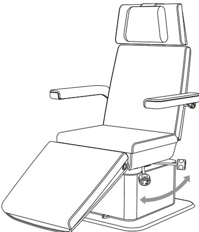
Handrad einfach lösen und wie dargestellt in die gewünschte Position verstellen.
