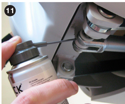
11 RÜCKENTEILEMOTOR SCHMIEREN. DAZU DIE LIEGE GANZ NACH OBEN UND IN LEICHTE RÜCKENLAGE FAHREN.
