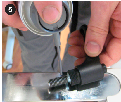
KLEMMHEBEL (GEWINDE) SCHMIEREN.
