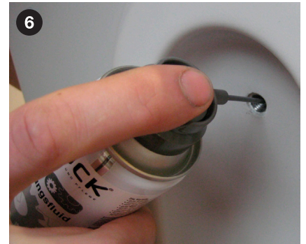
GEWINDE DER FESTSTELLSCHRAUBE AM KOPFTEIL SCHMIEREN.
