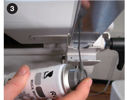
FÜHRUNGSRÖHR SOWEIT WIE MÖGLICH VON INNEN EINSPRÜHEN.
