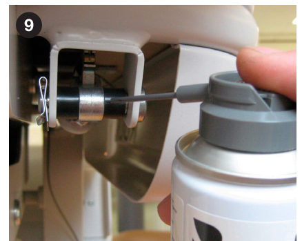
GASDRUCKFEDER UNTERHALB DER BEINAUFLAGE SCHMIEREN.
