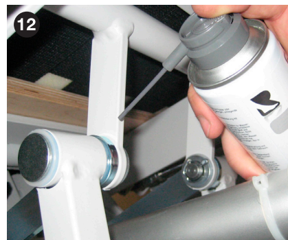
12 SCHERENGESTÄNGE SCHMIEREN. DAZU DIE LIEGE GANZ NACH OBEN UND IN LEICHTE RÜCKENLAGE FAHREN.
