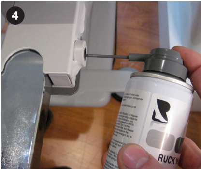
GEWINDE FÜR KLEMMHEBEL SCHMIEREN.
