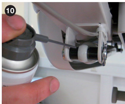
10 GASDRUCKFEDER AN DER RÜCKSEITE DER BEHANDLUNGSLIEGE SCHMIEREN.
