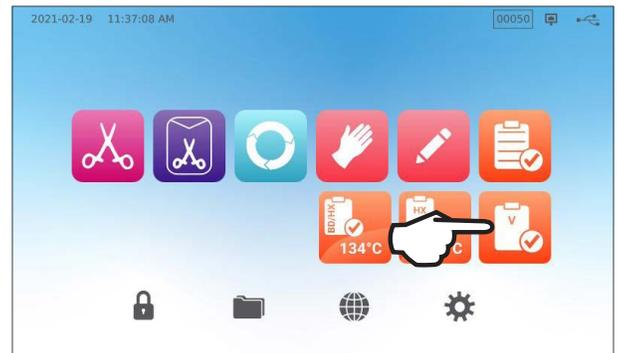
2. Um einen Vakuumtest durchzuführen, müssen Sie auf das Symbol **V** drücken.
