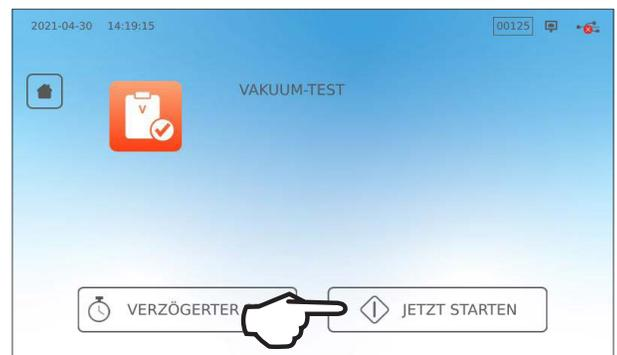
Den Vakuumtest durchzuführen dauert mindestens 15 Minuten. Wenn der Test abgeschlossen ist, wird auf dem Bildschirm die Meldung „ZYKLUS ABGESCHLOSSEN“ angezeigt. Falls der Test fehlgeschlagen ist, siehe Abschnitt 11. Fehlerbehebung.
