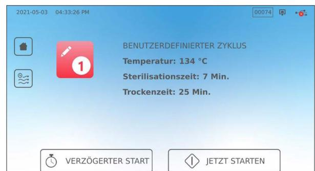
**ACHTUNG!** Zu jeder Temperaturoption gibt es eine voreingestellte Mindeststerilisationsdauer und Trocknungszeit. Befolgen Sie bei der Einstellung von Dauer und Temperatur die Anweisungen des Instrumentenherstellers zur Wiederaufbereitung. Andernfalls können Schäden an den Instrumenten und/oder am Autoklav auftreten.
