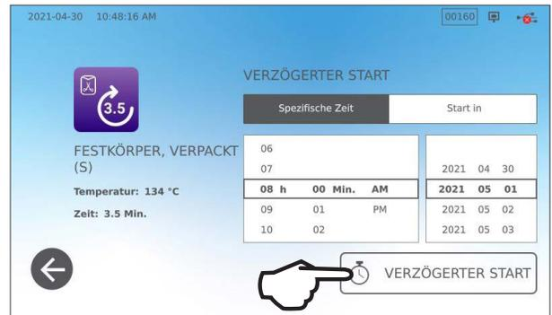
3. Der LCD-Bildschirm zeigt bis zum Beginn des Zyklus weiterhin die Seite „Verzögerter Start“ an. Drücken Sie die Taste **STOPP**, wenn Sie die geplante Startzeit ändern oder zurücksetzen möchten.
