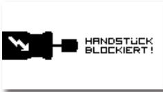
„HANDSTÜCK BLOCKIERT!“ - Beim Blockieren des Handstückes wird nach ca. 5 Sek. die Motordrehzahl sowie die Saugturbine abgeschaltet. Nach ca. 10 Sek. verschwindet diese Displayanzeige und die Handstückdrehzahl kann neu eingestellt werden.
