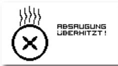
„ABSAUGUNG ÜBERHITZT“ - Nach Überschreiten der Lufttemperatur im Saugturbinegehäuse wird die Saugturbine sowie das Handstück abgeschaltet. Nach dem Absenken der Temperatur um ca. 10...15 °C verschwindet diese Displayanzeige und die Handstückdrehzahl kann neu eingestellt werden.
