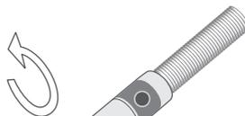
Ziehen Sie vorsichtig die Hülse ab, indem Sie gleichzeitig gegen die Metallkappe des Spannftutters drücken.
