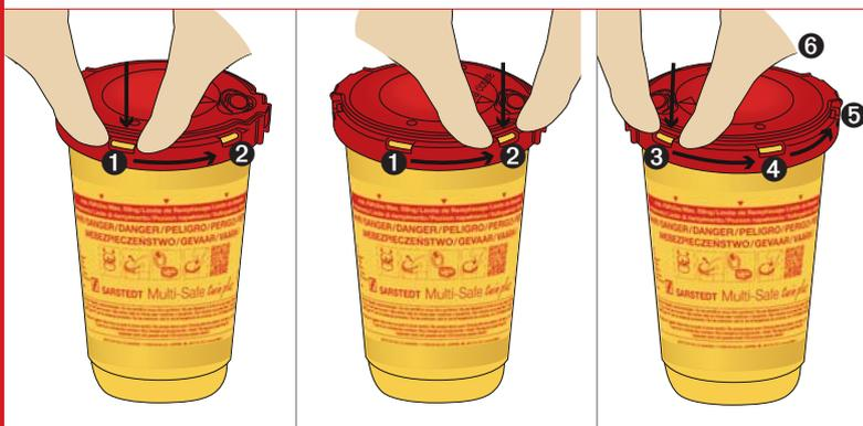
Deckel zentriert auf das Unterteil der Box aufsetzen. Durch gleichzeitiges Drücken mit beiden Daumen rechts und links neben den Aussparungen im Deckel den Deckel fest auf das Unterteil drücken, bis die Außenkante des gelben Unterteils hör- und sichtbar einrastet (1). Bitte wiederholen Sie diesen Vorgang rundherum entsprechend auch für die übrigen Aussparungen (2-6).
