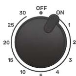
Den **Drehknopf** Reinigungsdauer auf **ON** drehen, um das Gerät für maximal 6 Stunden einzuschalten.
