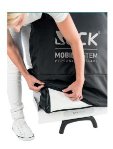
Ziehen Sie nun die Regenhülle über den RUCK® MOBIL SYSTEM TRANS-PORTER VELO (Art.-Nr. 11030). Eine Aussparung für den Kupplungsstift ist vorgesehen. Der Gummizug muss bis nach unten gezogen werden und die Einheit komplett umschließen.
